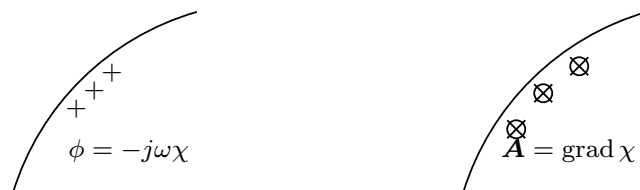
図 9.2 導体内のポテンシャル。電場と異なり、ポテンシャルは表面で連続でなければならない。面垂直方向の微分は表面で不連続となる。
